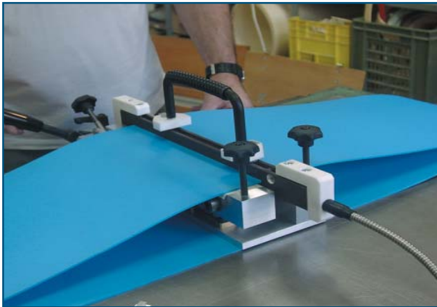
Soudure "Bout à bout" avec la pince FBW
