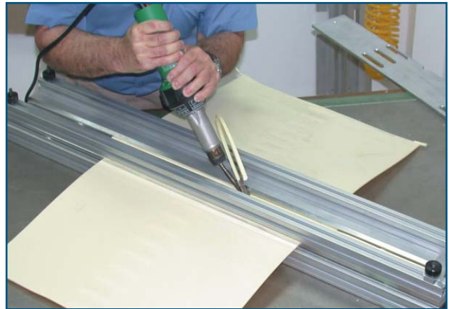
Soudure à air chaud avec la pince FT
