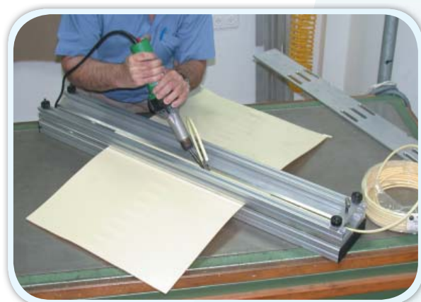
Soudure à air chaud avec le système FT
