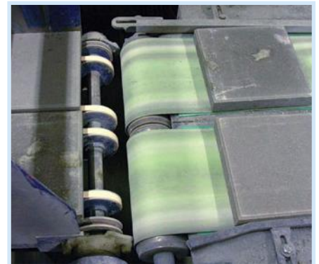
FK - 3 Transporte de ladrillo previo al horneado
