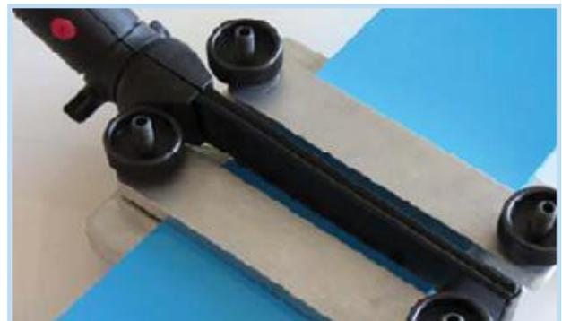
Schweißen von schmalen Flachbändern mit der Zange P-200
