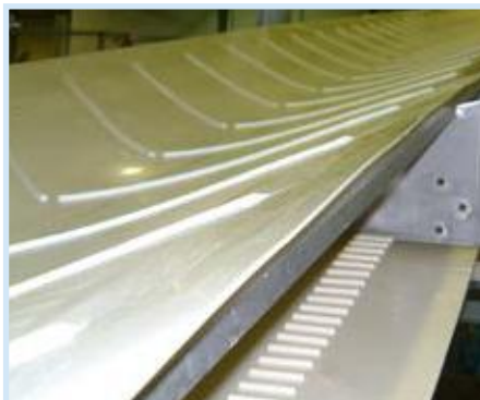
Banda cóncava SuperDrive™ con separadores en V
