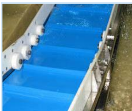
Banda SuperDrive™ con separadores funcionando bajo el agua
