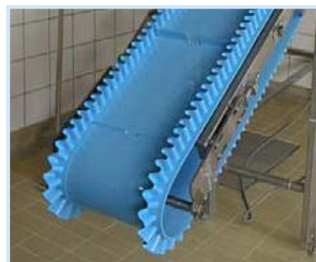
Banda SuperDrive™ con paredes y separadores laterales
