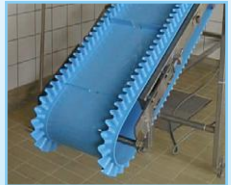
สายพาน SuperDrive™ แบบติด sidewalls และ บั้งพิเศษ
