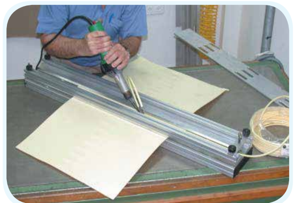
Stabschweißen von Profilen
